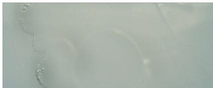
在面漆干燥过程中，面漆失去光泽且很均匀地反映出下层涂料的瑕疵，如显现腻子修补块和底材刮痕的形状，这种现象称为沉色。由于修补涂装时的打磨不良，产生光泽不均现象称为阴影。
