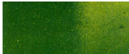
漆膜表面受大气中的阳光、氧气和水分的作下，老化呈粉状脱落，表面出现有色粉末的现象。气候和使用年度都可以影响粉化程度。
