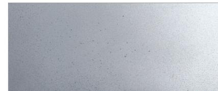
复色漆在涂装过程中或干燥成膜时，涂膜的颜色局部不均匀，出现斑纹、条纹和色相杂乱现象。
