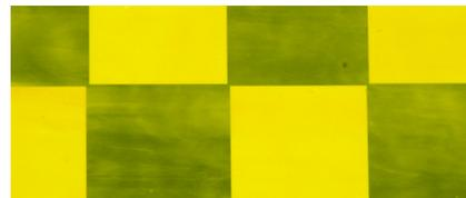
由于喷得太薄，膜厚不足或涂料中颜料的遮盖力差，透过漆膜能看到底色的现象。
