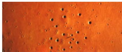
漆膜上有针状小孔或像皮革的毛孔那样的小孔的现象称为针孔，它不仅在表面有凹坑，且深达到底层。
