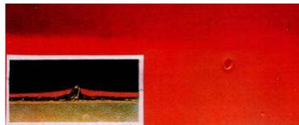
涂料经涂装后，涂膜中的凸起物呈颗粒状分布在整个或局部表面的现象称为颗粒；在涂装时或刚涂装完的湿漆膜上附着的灰尘或异物称为尘埃。
