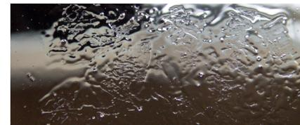
涂膜按工艺规范自干或烘干后未达到完全干固，手摸漆膜有湿润返潮的感觉，漆膜整体硬度偏低，漆膜发软或存在表干里不干的现象。严重时受阳光长时间照射后出现回粘现象。
