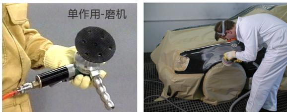
清除了涂膜的边缘是很厚的。为产生一个宽的、平滑的边缘，可以将涂膜的边缘打磨形成一个平滑的斜坡就叫做羽状边，直径口应该大于2-3厘米。
