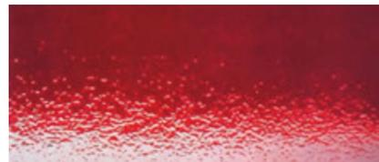
在喷涂时涂膜表面出现类似桔皮、柚子皮那样的皱纹。主要是因雾化的细小油漆质点到达漆面时，相互间不能流动，结合不良所致。
