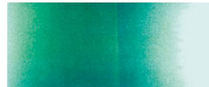
涂膜在使用过程中颜色发生变化，其色相、明度、彩度明显地偏离标准板（或原色板）的现象称为变色；如果漆膜的颜色变浅，彩度变小或明度变大的现象称为褪色；而白色、浅色包括清漆在日光、紫外线或加热时转变为黄色或褐色的现象称为黄变。
