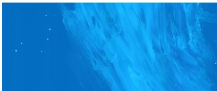
由于涂料中各种颜料的粒度大小、形状、密度、分散性、内聚性等的不同，使漆膜表面和下层的颜料分布不均，各断面的色调有差异的现象。
